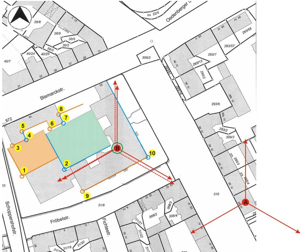
Bild 1: Lage der realisierten UMTS-Basisstation („B“) und der Messpunkte („1“, „2“, „6“ und „10“) sowie Alternativstandort („A“)
