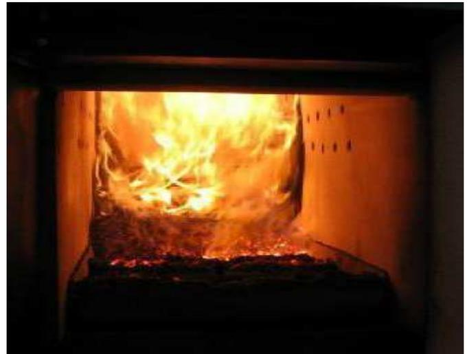
Bild 3: Brennkammer mit Vorschubrost.
