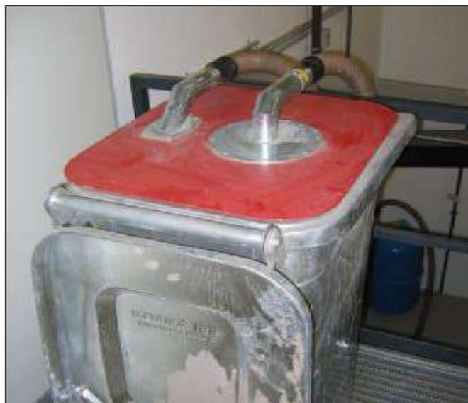
Bild 8: Mülltonne als Vorabscheider für Staubsaugerbetrieb.
