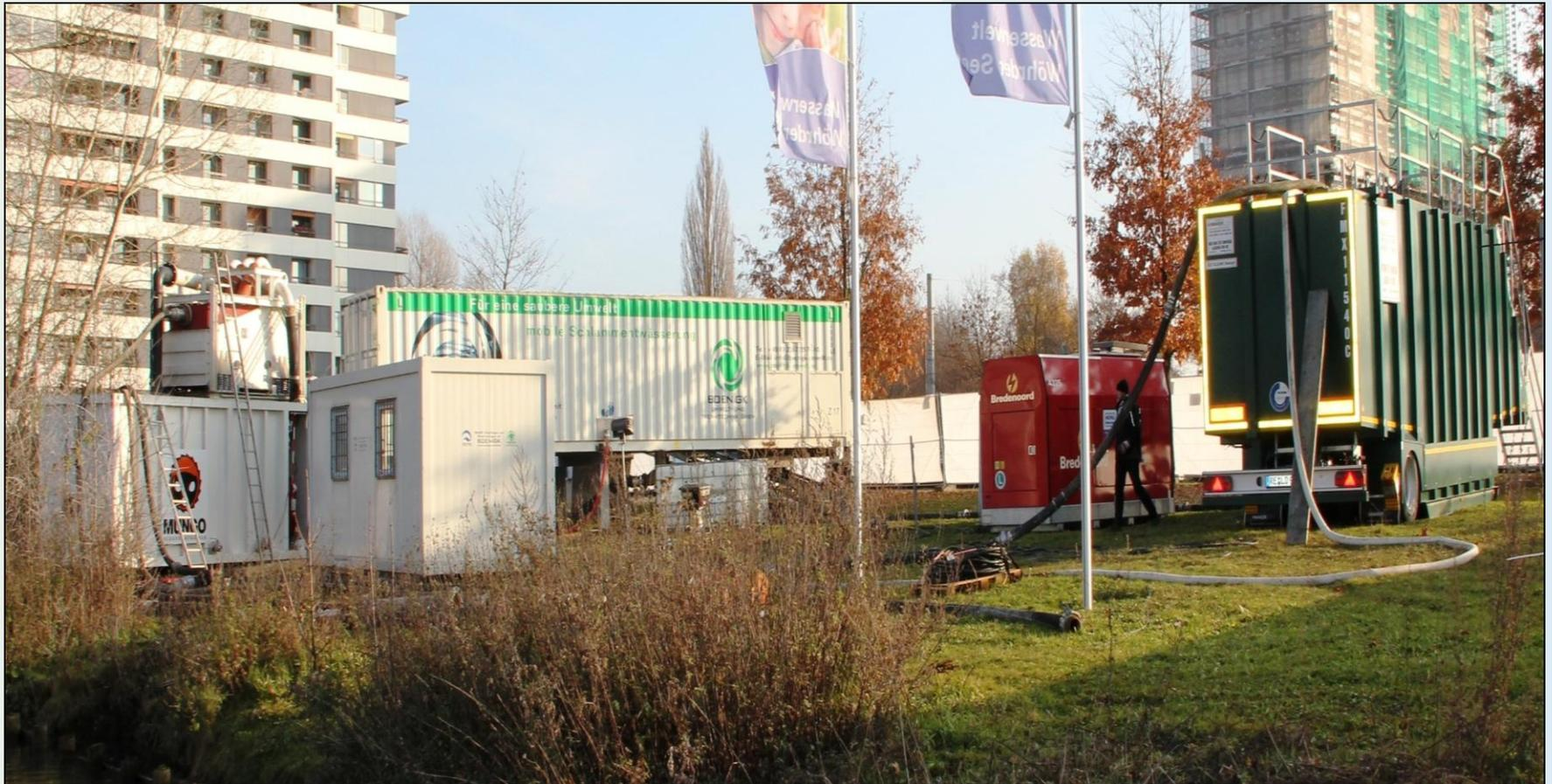
1. Versuch: Entwässerung des Schlammes mittels Zentrifugen (Herbst 2011)
