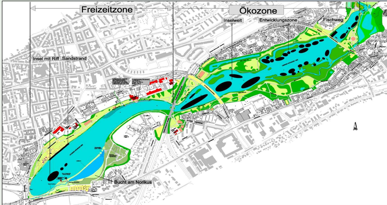
Durch Einengung des Fließquerschnittes wird die Fließgeschwindigkeit des Wasser erhöht wodurch Schlammablagerungen künftig stark vermindert werden.
