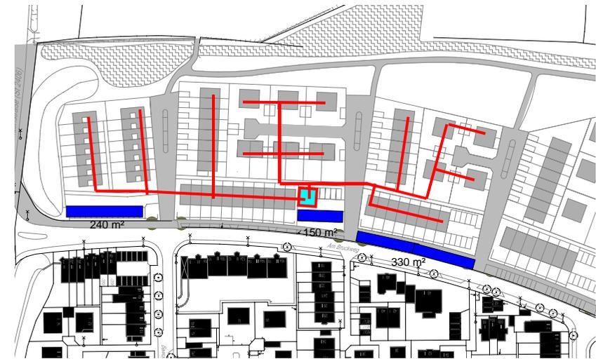
Bild 11: Mögliche Netzverlegung durch die Reihenhauszeilen, Kollektorflächen auf Carport-Dächern
