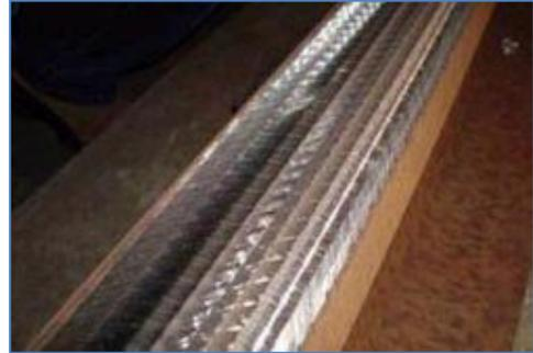
Überwiegend wird als Reparatur- bzw. Erhaltungsmaßnahme an Schienen das sog. Reprofilierungsschleifen durchgeführt, welches aufgrund des hohen Aufwandes (Sperrung des Schienenwegs für den Regelbetrieb) meist in großen Zeitintervallen erfolgt. Das (ausschließliche) Reprofilierungsschleifen ist aus akustischer Sicht nachteilig, weil dadurch eine vermeidbare Riffelbildung der Schienenköpfe mit entsprechenden Lärmauswirkungen zwischen den seltenen Schleifvorgängen zugelassen wird.
