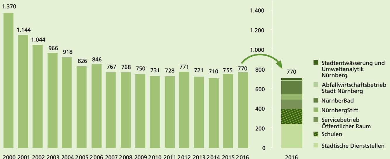
Gegenüber dem Stand im Jahr 2000 sanken die CO<sub>2</sub>-Emissionen um ca. 45% auf rund 68.700 Tonnen im Jahr 2016. Großen Anteil an dieser weiterhin sinkenden Tendenz und damit an der positiven Entwicklung hat die Umstellung des Heizkraftwerkes der N-ERGIE von Kohle auf Erdgas sowie die Nutzung von Abwärme der Müllverbren-
