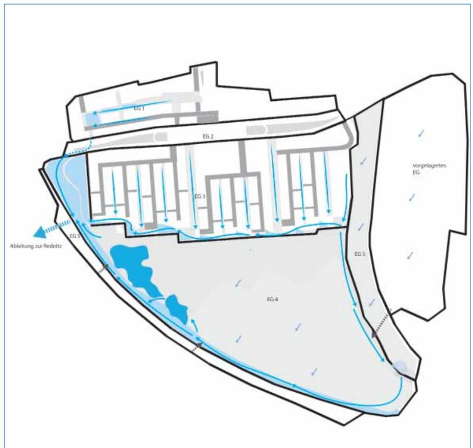
Abbildung 11: Geplante naturnahe Ableitung von Niederschlagswässern aus den geplanten Neubaugebieten im Tiefen Feld - Ableitungs- und Retentionsschema (Quelle: Ramboll Studio Dreiseitl 2016 [150])
