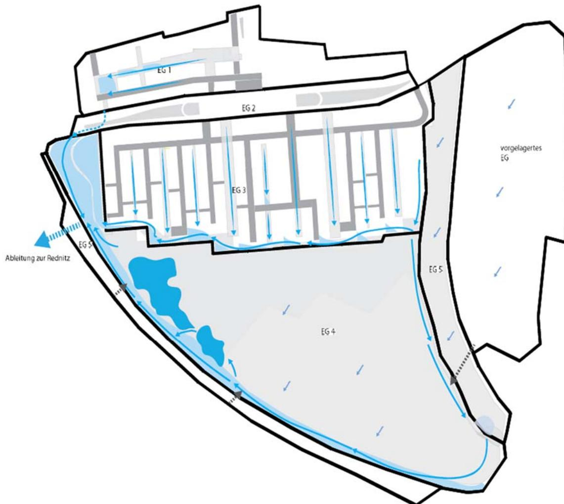
Abbildung 1: Abfluss- und Retentionsschema für das Planungsgebiet (Quelle: Ramboll Studio Dreiseitl GmbH, 2019)
