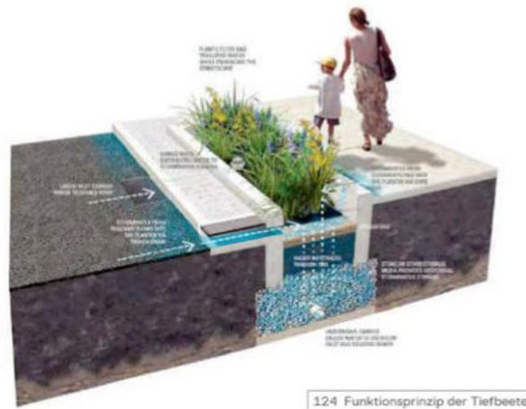
Abbildung 30: Tiefbeet (schematische Darstellung)
