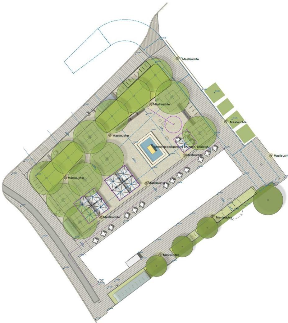
Beleuchtung: Wie im Bestand soll die Platzfläche künftig mit Mastleuchten ausgeleuchtet werden, da dies das effektivste System darstellt (Lichtverschmutzung, optimale Ausleuchtung Bodenflächen, wenige Lichtpunkte genügen für große Flächen). Die Leuchten umfassen den inneren Platzbereich und werden entlang der linearen Bankelemente bzw. der südlichen Platzkante angelagert. Die genaue Platzierung muss im weiteren Planungsverlauf noch abgestimmt werden.
