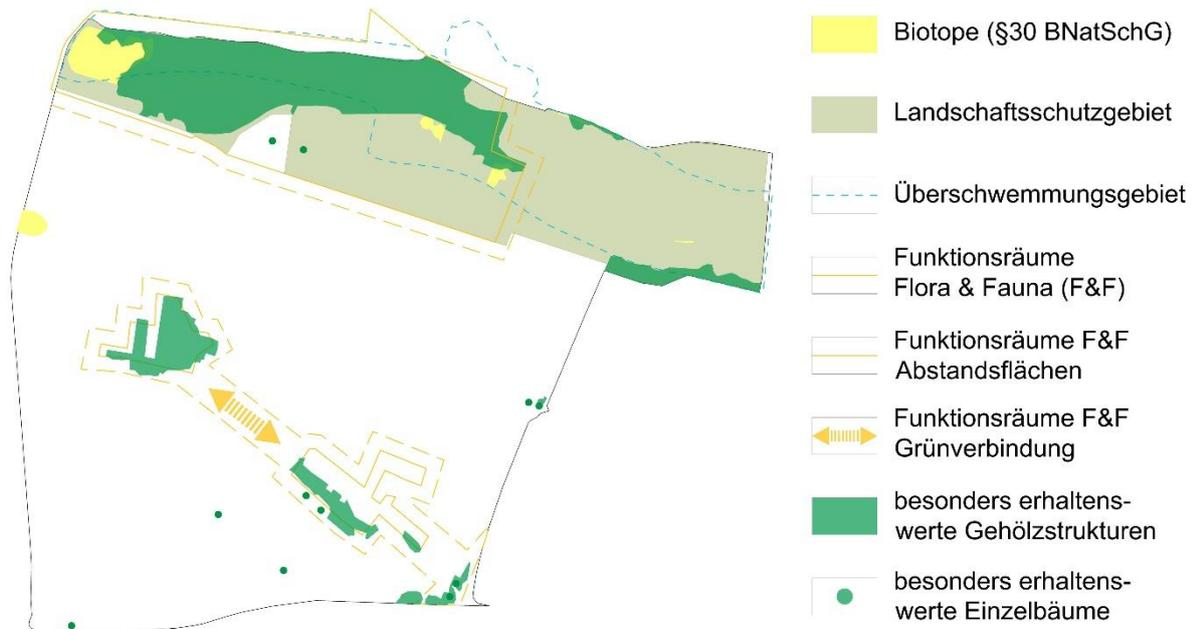
Abbildung 35: Flächen, welche für eine bauliche Entwicklung grundsätzlich nicht zur Verfügung stehen
