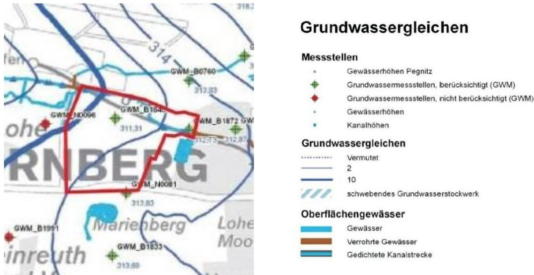
Abbildung 13: Ausschnitt aus dem Grundwasserbericht (U<sub>2</sub>) mit Darstellung der Grundwassergleichen und Lage des Untersuchungsgebietes
