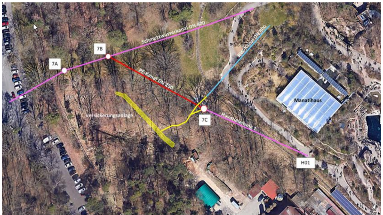
Abbildung: umgesetztes Entwässerungskonzept
