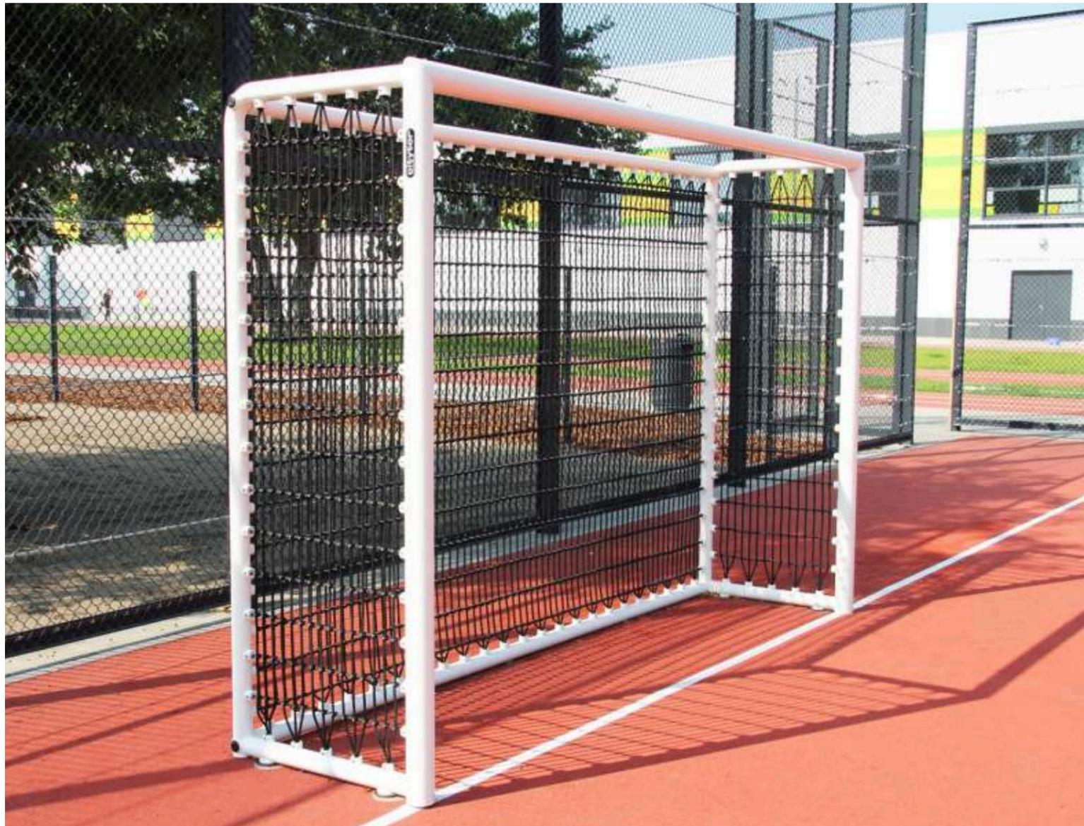
Jugend-citytor, Bolzplatztor 5,0x2,09m, Rahmenkonstruktion aus Stahlrohren, verzinkt und pulverbeschichtet gem. Farbpalette, Tornetz aus Herkulesseil mit Stahlanteil, Seilfarbe gem. Farbpalette, Verankerung auf Punktfundamente geschraubt
